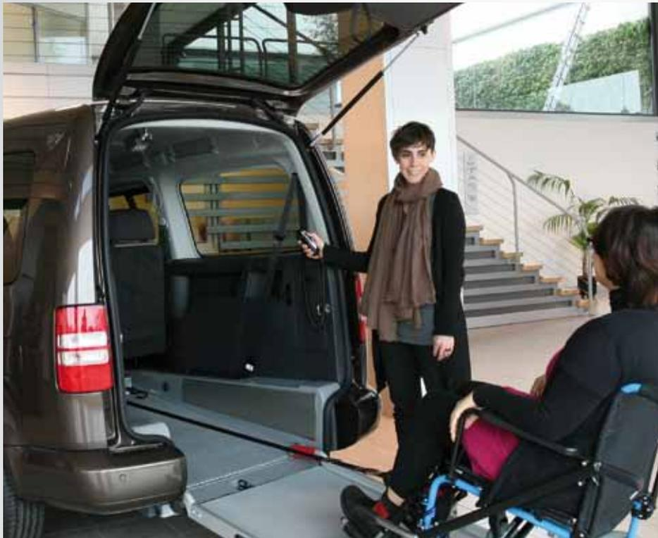
**F-Winch est le treuil permettant de remorquer le fauteuil roulant sur une rampe de manière sûre et confortable.**
