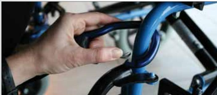
Il suffit tout simplement d'accrocher les mousquetons au châssis du fauteuil roulant et régler la vitesse de remorquage par le joystick ergonomique.
