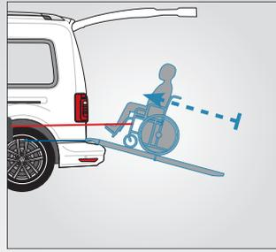
**F-WINCH®** Mit F-Winch können Sie einen Rollstuhl auf der Rampe in einem komfortablen und sicheren Weg, ziehen.
