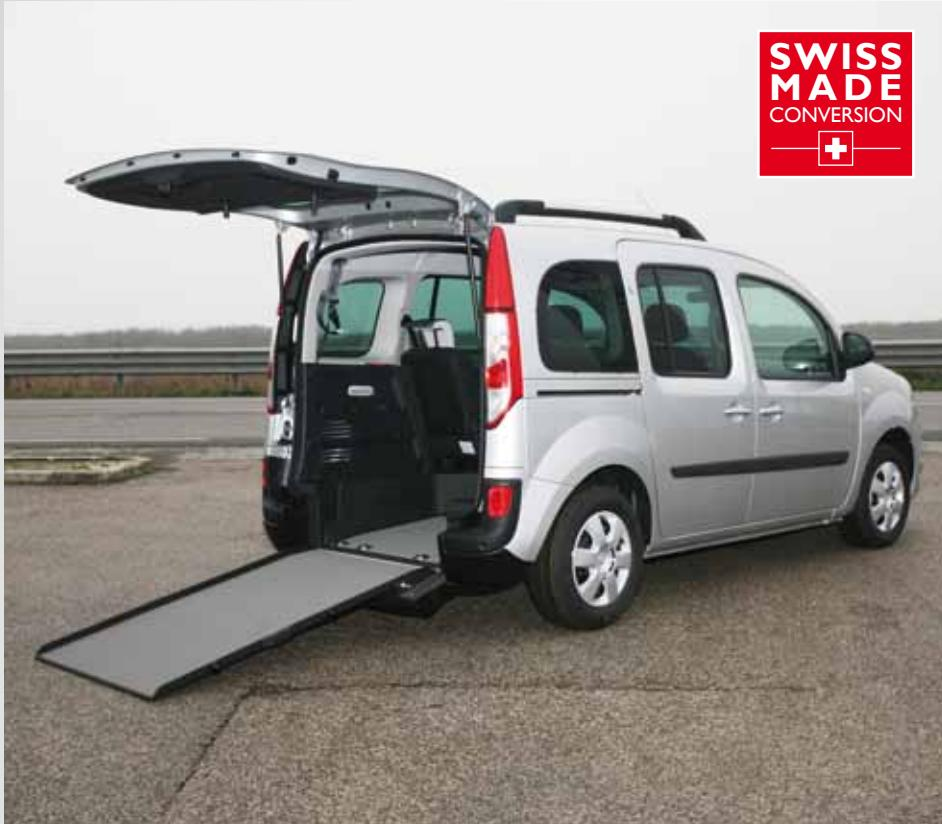
Die Zugangrampe ist verfügbar in zwei Versionen: manuell und automatisch. Die Benutzung der Rampe in dieser Version ist möglich fernbedient, um die Bewegung, und so die Senkung und die folgenden Schließung zu erlauben
