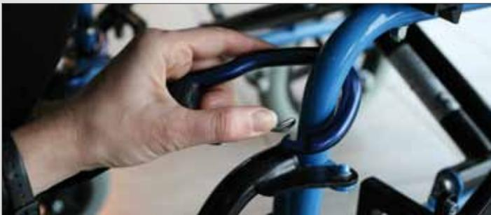
Basta semplicemente agganciare i moschettoni al telaio della carrozzina e regolare la velocità di traino con il joystick ergonomico.
